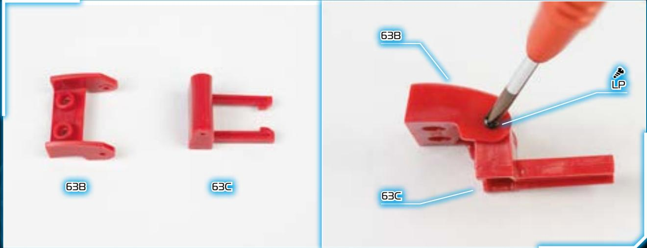
1 - Петля собирается из деталей (63B) и (63C), а затем крепится к пластине (63A). Соедините указанные детали так, чтобы их отверстия совпали, после чего скрепите обе детали винтом LP.
